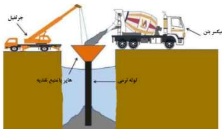
شکل ۳-۱۴ تصویر شماتیک از بتن‌ریزی به روش ترمی در زیر آب و جزئیات به کار رفته.
