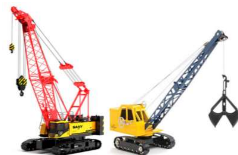
شکل ۳-۸۰ تصویر شماتیک از جرثقیل بوم خشک که می توان یک چنگک را جهت تخلیه خاک به آن آویزان نمود
