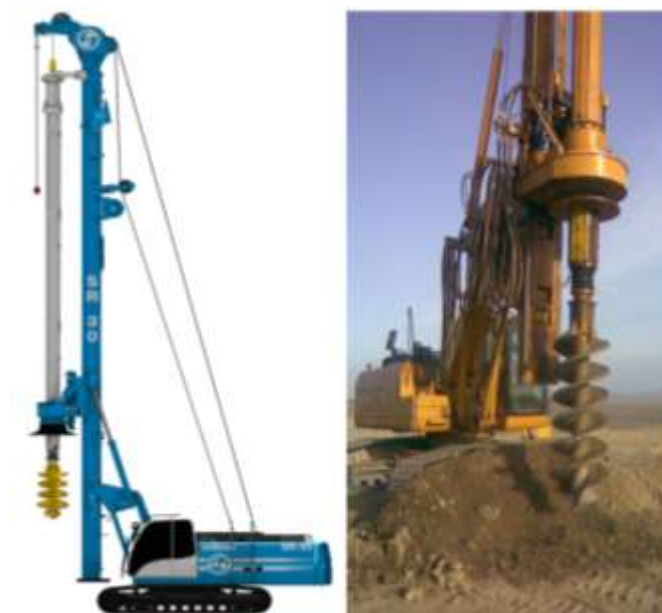
شکل ۳-۲ یک نمونه دستگاه حفار روتاری (دورانی) شمع.
