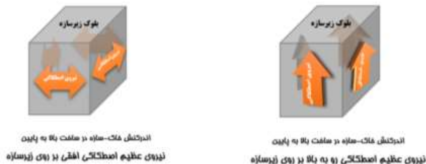
شکل ۲-۱ اندرکنش اصطکاکی وارد به بلوک زیرسازه
