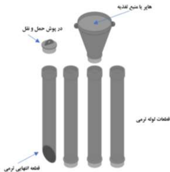
شکل ۳-۱۳ جزییات تشکیل دهنده لوله ترمی
