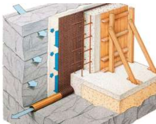
شکل ۳-۱۲۱ آب‌بندی طرف مثبت برای دال کف و دیوار زیرزمین
