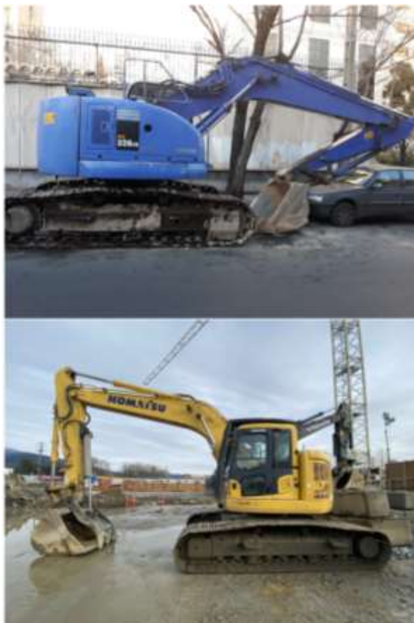
شکل ۷۵-۳ بیل مکانیکی با فرم خاص برای کار در شرایط محدودتر
