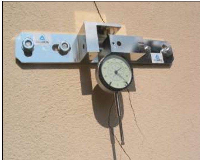
شکل ۵-۱۰ ترک سنج دو بعدی با گیج قرائت عقربه‌ای
