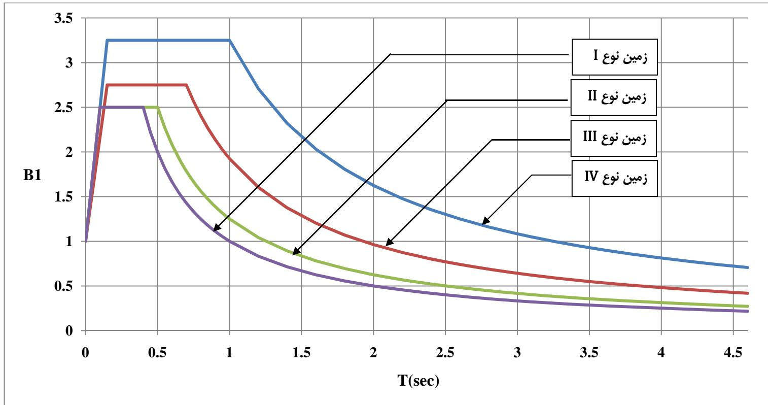
شکل ۱-۲-الف- ضریب شکل طیف طرح برای انواع زمین‌های مندرج در بند(۴-۲) با خطر نسبی کم و متوسط
