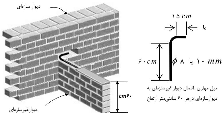
شکل ۱۵-۷ نحوه قفل و بست دیوار غیرسازهای به دیوار سازهای
