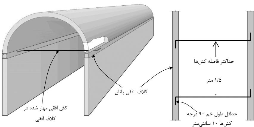
شکل ۳۱-۷ تعبیه مهاربندهای افقی در طاق‌های قوسی استوانه‌ای
