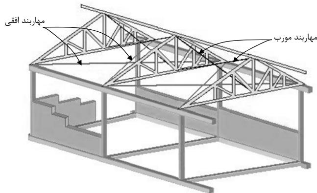
شکل ۳۰-۷ تعبیه مهاربندهای فائیم و افقی در خرپاها
