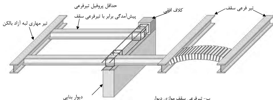
سقف بالکن و سقف طبقه باید با رعایت جزئیات اتصال یکپارچه شده و همزمان اجرا شوند
