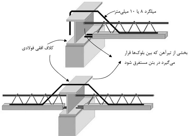
شکل ۷-۲۹ نحوه اتصال تیرچه‌های سقف به کلاف افقی بتنی و فولادی
