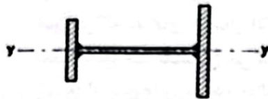
مقطع I شکل دو بال نامساوی برای خمش حول محور ضعیف
