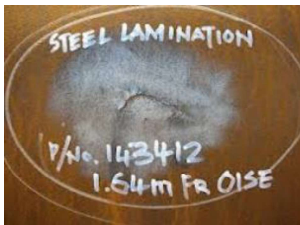
شکل ۱-۲۶ تورق ناشی از جوشکاری
