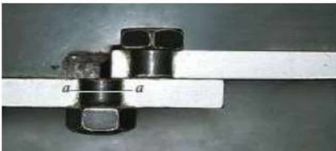
نمایش تنش برشی در مقطع پیچ‌ها
