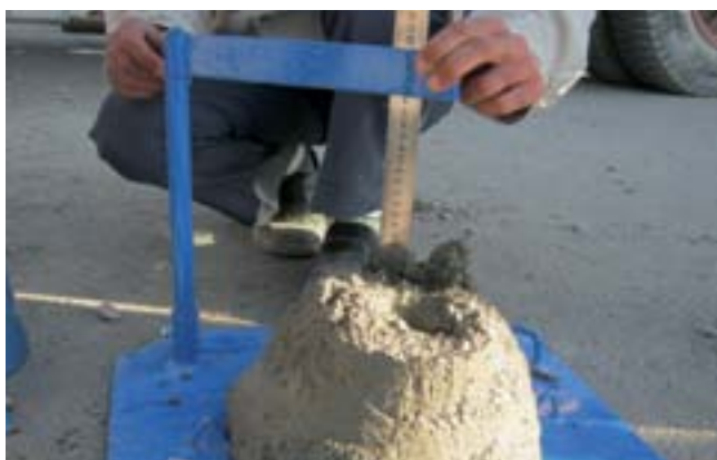
شکل ۵ - اندازه‌گیری میزان افت بتن در آزمایش اسلامپ
