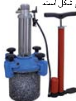
شکل ۷- دستگاه کنترل هوای بتن
