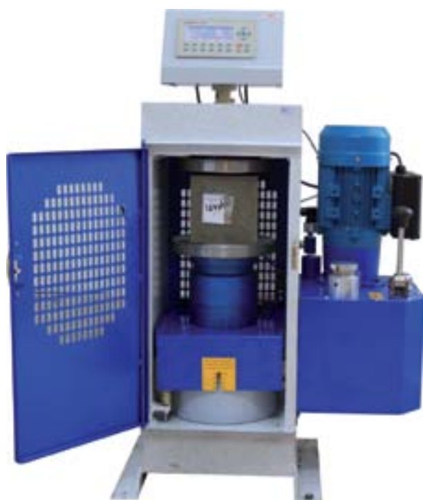
شکل ۹- دستگاه آزمون مقاومت فشاری بتن (جک بتن شکن دیجیتال)
