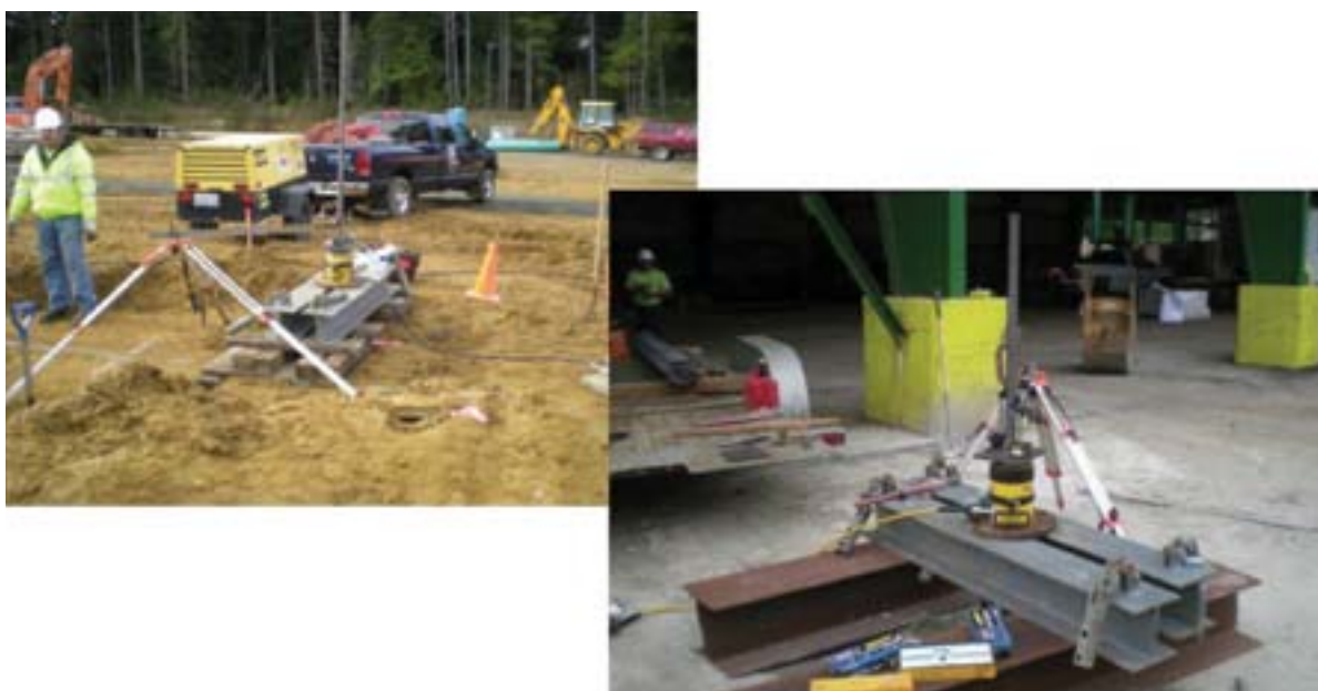
شکل ۹ - تجهیزات آزمایش بارگذاری میکروپایل
