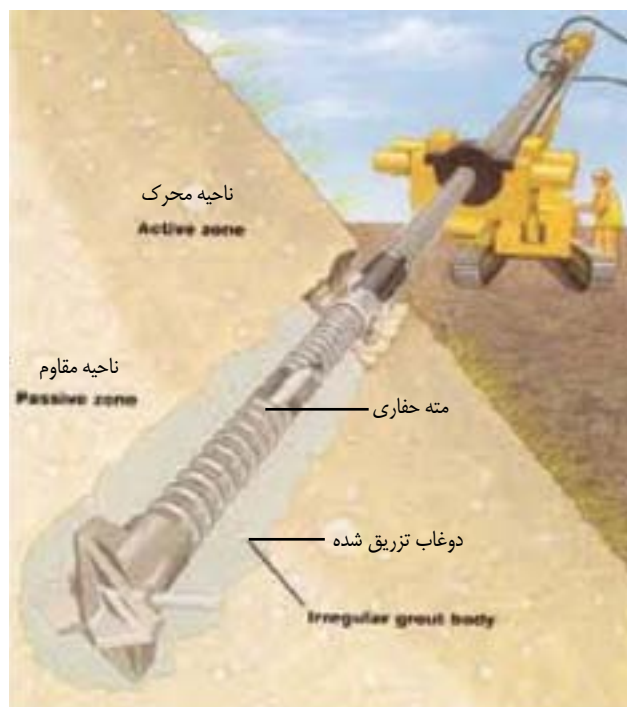
شکل ۵- دستگاه های حفاری جهت قرار دادن میکروپایل ها
