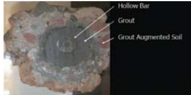
شکل ۶- عملیات تزریق در میکروپایل
