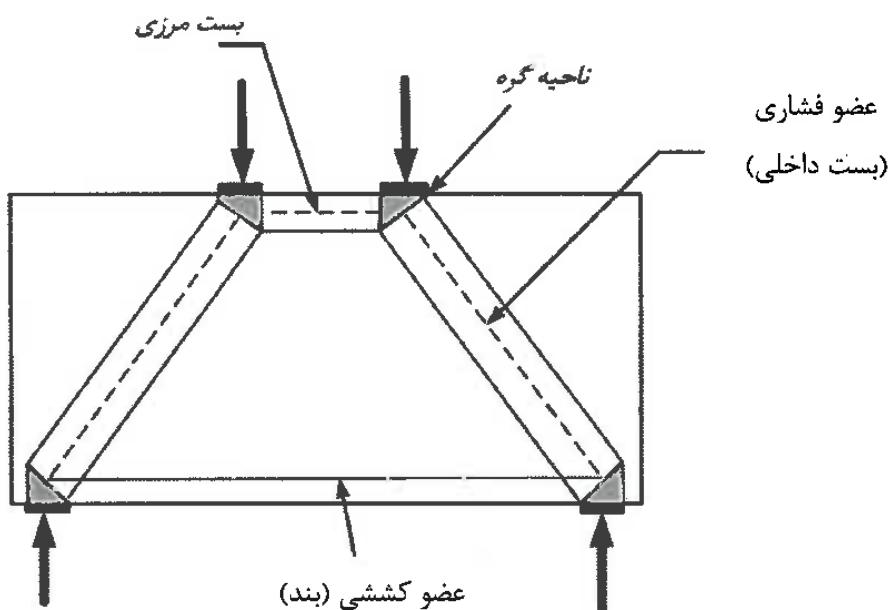
شکل ۹-پ ۳-۳ اجزای مدل خرپایی (بست و بند)
