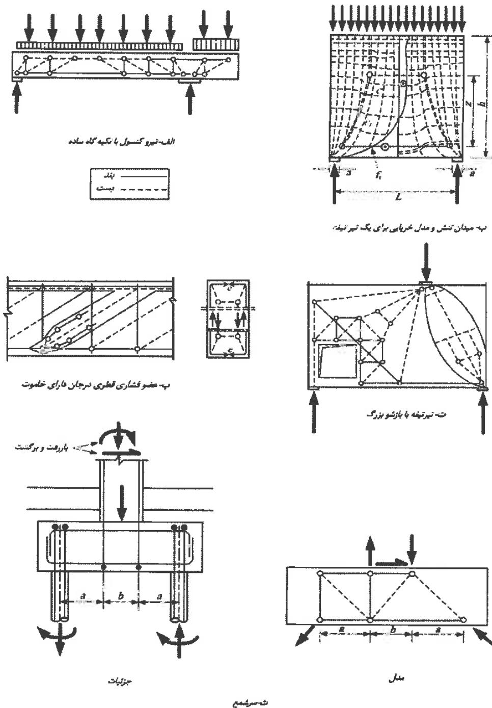
شکل ۹-پ ۴ مدل‌های خربایی شامل اعضای فشاری و کششی که نشان‌گر میدان تنش میباشند.
