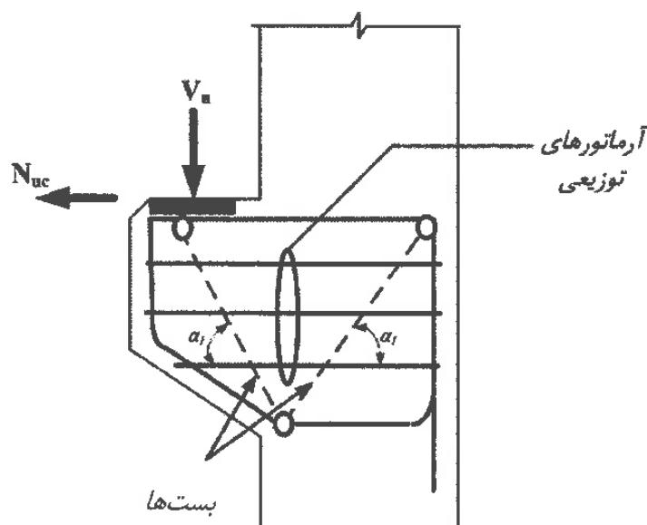
شکل ۹-پ ۳-۶ آرماتورهای توزیعی عرضی بست‌ها (زاویه‌ی آرماتورهای عرضی با بست‌ها حداقل ۴۰ درجه باشد)
