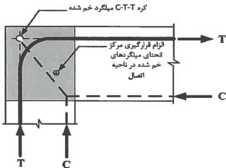
شکل ۹-پ ۱۰-۳ الزام قرارگیری مرکز انحنای میلگردهای خم شده در ناحیه‌ی اتصال
