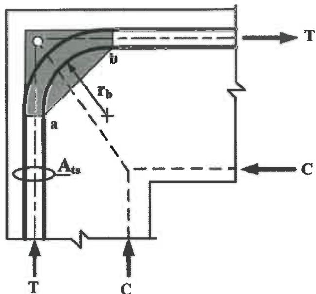
شکل ۹-پ ۳ شعاع داخلی خم برای چند ردیف میلگرد
