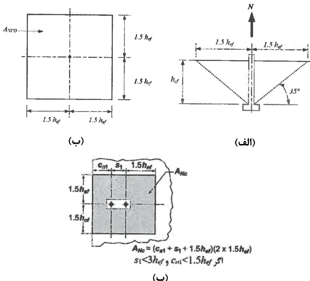
شکل ۱۸-۹ نحوی محاسبه مساحت سطح گسیختگی تصویر شده، (الف) مقطع تعیین  $A_{Nco}$ ، (ب) پلان تعیین  $A_{Nco}$
