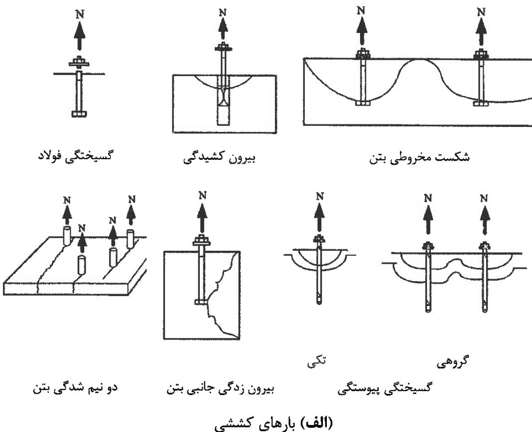
شکل ۹-۲-۱۸-۹- انواع حالات گسیختگی مهارها در کشش و برش
