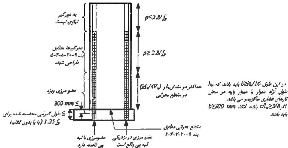
الف- دیوار با نسبت  $\frac{h_w}{w} \geq 2.0$  و یک مقطع بحرانی که طراحی آن برای خمش و بار محوری و با استفاده از بندهای ۲۰-۹ و ۴-۷-۲۰-۹ و ۴-۷-۲۰-۹ و ۵-۴-۷-۲۰-۹ انجام می‌شود.
