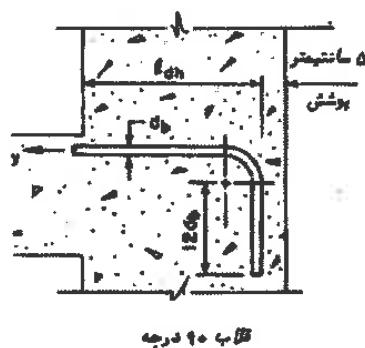
شکل ۹-پ ۵ چگونگی اتصال تیر به ستون در گوش
