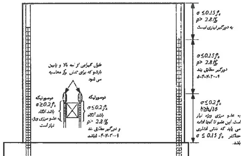
یادداشت: در مواردی که تنش فشاری حداکثر در تارهای انتهایی  $\sigma \leq 0.2f_y$  باشد الزامات جزء مرزی ویژه باید رعایت شوند. جزء ویژه مرزی، باید تا آنجا ادامه باید که تنش فشاری حداکثر  $\sigma < 0.15f_y$  باشد. در این موارد با توجه به اینکه  $\frac{h_w}{w} \leq 2.0$  است ضوابط بند ۲۰-۹-۷-۲۰-۹-۴(ب) کاربرد ندارند.
