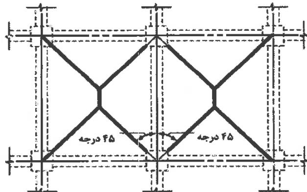
شکل ۲-۱۰-۹ سطح بارگیر برای محاسبه‌ی برش تیرهای داخلی
